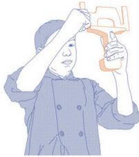
Apprenti du Service Électrique et de la Signalisation (SES) vérifiant la planéité d'une pièce à l'aide d'un calibre dans l'école du Moulin Neuf à Chambéry.
